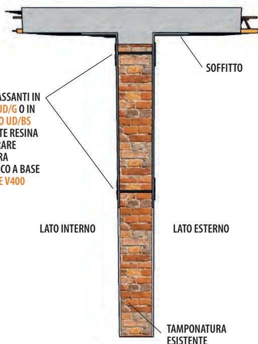
FIOCCHI DI COLLEGAMENTO PASSANTI IN FIBRA DI VETRO TIPO **FIOCCO UD/G** O IN FIBRA DI BASALTO TIPO **FIOCCO UD/BS** DA PREIMPREGNARE MEDIANTE RESINA FLUIDA **EPOFLUID** E DA ANCORARE ALL'INTERNO DELLA MURATURA MEDIANTE ANCORANTE CHIMICO A BASE VINILESTERE TIPO **ANCORANTE V400**
