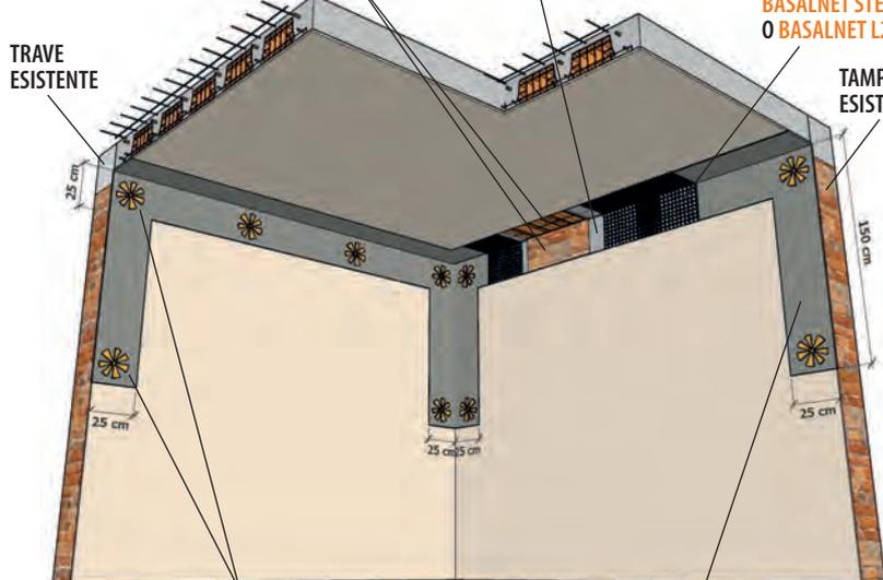
5) FIOCCHI DI COLLEGAMENTO PASSANTI IN FIBRA DI VETRO TIPO **FIOCCO UD/G** O IN FIBRA DI BASALTO TIPO **FIOCCO UD/BS**
